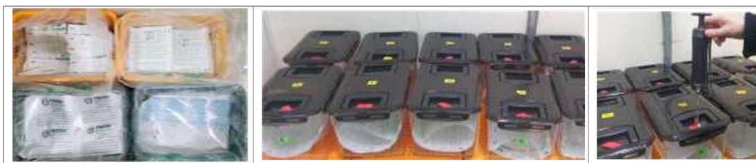
그림 1. 유황패드의 SO 2 발생량 측정
